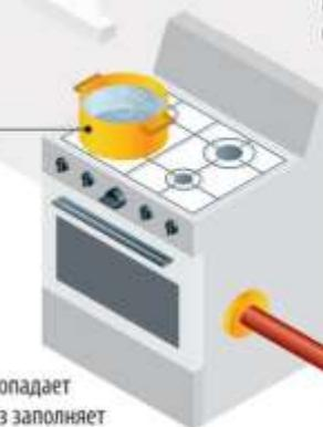
От долгой или неправильной эксплуатации происходит разрыв шланга, соединяющего газовую магистраль с плитой. Газ постепенно заполняет помещение. Искра – взрыв
