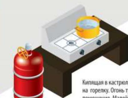
Кипящая в кастрюле вода попадает на горелку. Огонь тухнет. Газ заполняет помещение. Малейшая искра (зажженная спичка, нажатие клавишей выключателей и т.д.) приводит к взрыву
