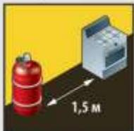
Удаление от плиты, печи или радиатора отопления не менее чем на 1,5 м
